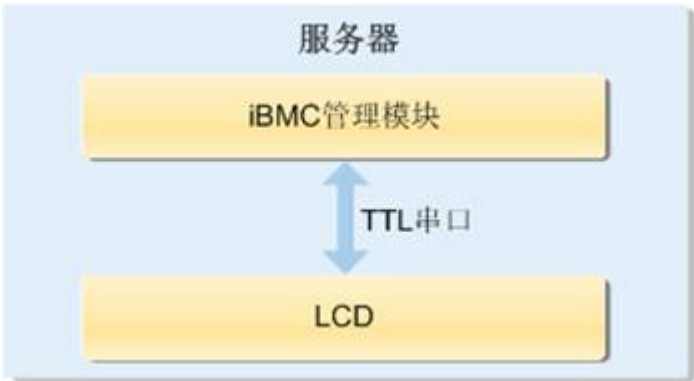
图 5-28 LCD 子系统工作原理
